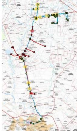
Los sistemas de transporte y distribución existente en los centros poblados de Los Árboles, Chauta y Las Mercedes se integran a red de conducción que sale del Tanque de Almacenamiento Elevado proyectado. Se subdividirá el sistema en dos (2) sectores hidráulicos
